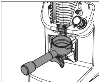
Машина оснащена держателем фильтра. Этот прибор подготовлен для стандартных фильтров Victoria Arduino, но может быть отрегулировано в соответствии с другими фильтрами.
