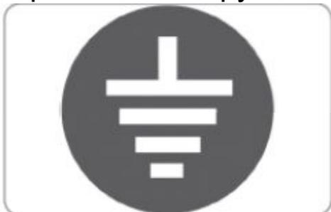
Производитель не несет ответственность за ущерб, сделанный неправильным подключением заземления. Для обеспечения электрической безопасности необходимо оборудовать систему правильным заземлением. Эти работы должны быть выполнены квалифицированным электриком, который должен гарантировать также, что электрическая мощность сети достаточная, чтобы выдержать максимальную нагрузку, указанную на табличке кофемашины.
