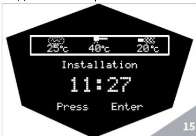
Нажмите кнопку Enter
