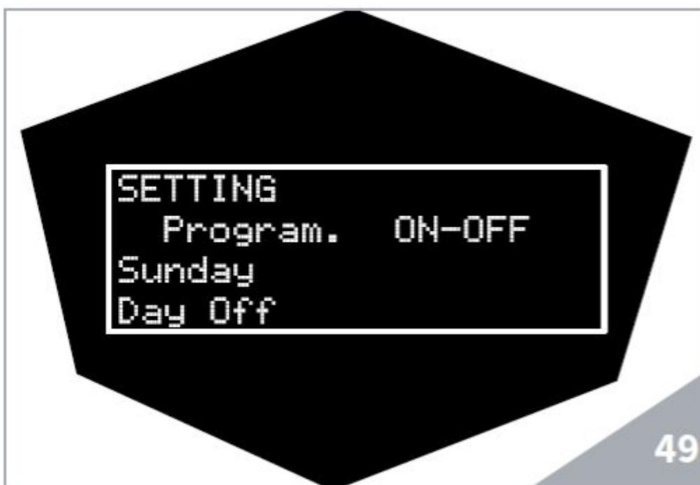
Заводская настройка- OFF (отключено), то есть ручное включение/выключение кофемашины.
