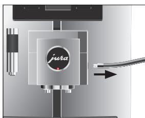
Если используется функция приготовления молока, для обеспечения безупречного функционирования комбинированного дозатора, а также из соображений гигиены, дозатор обязательно необходимо **ежедневно** разбирать и промывать.
