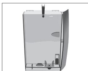
▶ Снимите бункер для воды и промойте его холодной водой.
