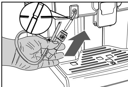
**15** Вставьте насадку Cappuccinatore таким образом, чтобы она не прилегала вплотную к гнезду, показанному на рисунке, предусмотренному в трубке подачи пара.
