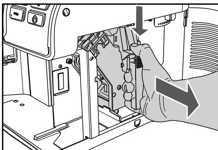
**6** Вымойте блок приготовления кофе теплой водой; тщательно промойте верхний фильтр. Перед тем как вставить блок приготовления кофе на место, убедитесь, что внутри камеры подачи не осталось воды.
