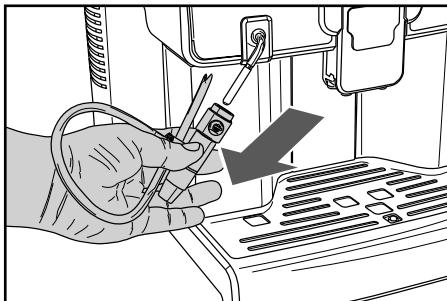
**10** Снимите всасывающую трубку с Cappuccinatore.
