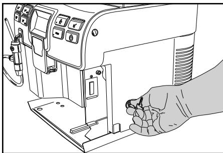
**5** Извлеките блок приготовления кофе, взяв его за специальную ручку и нажав кнопку «PRESS». Блок приготовления кофе можно мыть только теплой водой без моющего средства.
