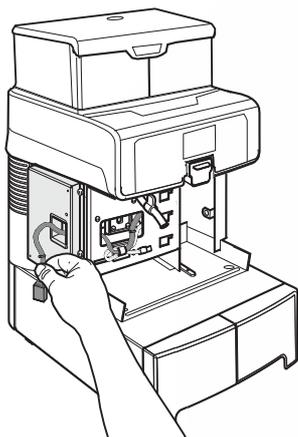
Установите бокс для монетоприемника на фиксатор с помощью двух винтов.
