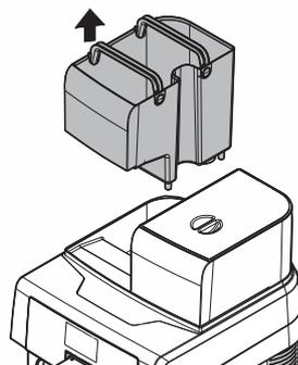
Вымойте бак и наполните свежей водой, не превышая верхнюю отметку (MAX) на баке.
