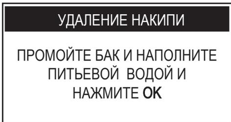
Тщательно промойте резервуар для воды и наполните его свежей питьевой водой до уровня MAX, указанного на задней части резервуара. Вставьте бак в машину. Нажмите кнопку «OK». Опорожните контейнеры, использованные для сбора жидкости, выдаваемой машиной.
