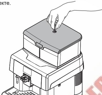
Поднимите и снимите крышку.
