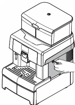
Снимите , потянув ее за ручку и нажав кнопку «PRESS». Данный элемент следует промывать только холодной водой. Не используйте моющие средства.
