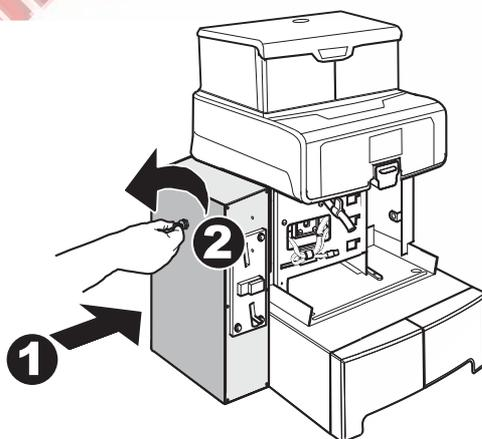
Поставьте на место переднюю панель, зафиксируйте винтом. Установите кран для выдачи кофе. Поставьте на место поддон для капель.
