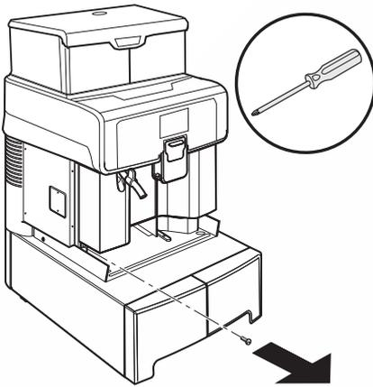
Снимите крышку слева, открутив два винта.
