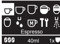
На дисплее отображается значок чашки и подпись к нему (например, «Espresso»). С помощью поворотно-нажимной ручки можно выбрать желаемый вид кофе.
