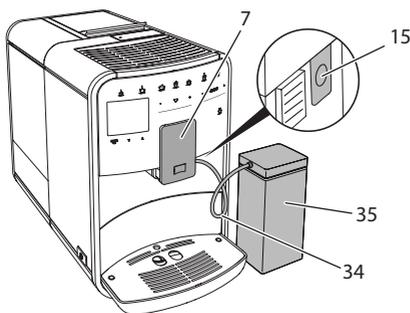
Рис. 12: Подключение емкости для молока к аппарату
