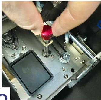
2 Выкрутить Фиксирующий болт
