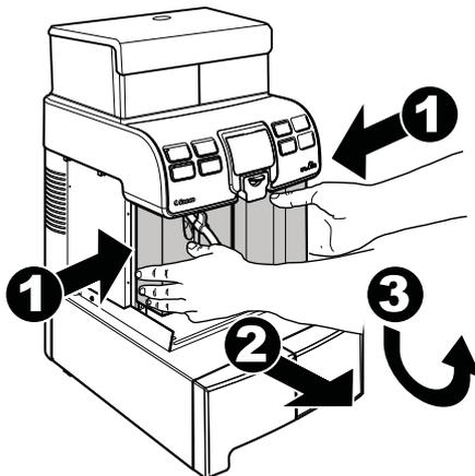
Снимите крышку на левой стороне, открутив 2 винта.
