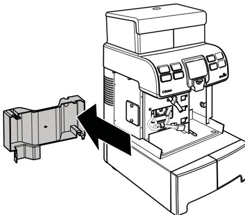
Установите на место и закрепите передний кожух с предварительно снятым винтом. Установите на место устройство подачи кофе. Установите на место поддон для сбора капель.
