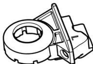
Правый штуцер для Cappuccinatore: позволяет подсоединить Cappuccinatore к емкости для молока, если в машине установлен монетоприемник.
