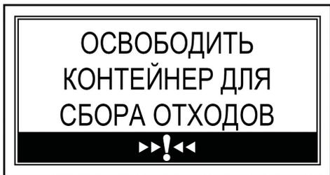
В этом случае машина не разрешает подачу кофе. Для восстановления работоспособности машины необходимо опорожнить контейнер для сбора отходов от отработанного кофе. Достаньте контейнер и удалите отходы кофе в подходящую емкость.
