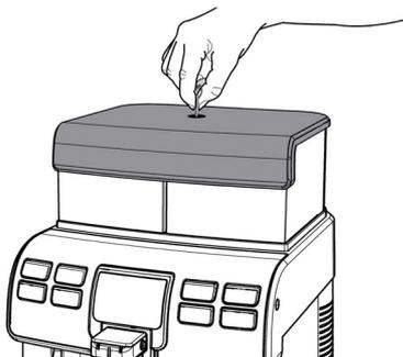
После разблокирования поднимите и снимите крышку.
