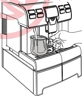
Нажмите кнопку «Горячая вода» для начала подачи горячей воды из трубки.
