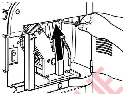
⚠ После отключения защитного микровыключателя открывается доступ к движущимся частям машины, что является опасным для оператора.
