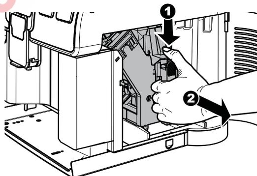
Приподнимите внутренний контейнер в задней части, чтобы отсоединить его.
